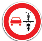
Aussage Verbot des Überholens von eispirigen Fahrzeugen für mehrspurige Kraftfahrzeuge und Krafträdern mit Beiwagen Zeichen 277.1
