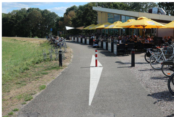
Bild 3: Niederlande: So stellt man Pfosten auf einer Radroute mit etwa 3 m Breite sicher: Es gibt drei Pfosten mit jeweils zwei Fahrspuren. die äußeren Pfosten sind zwars dunkel, besitzen aber ebenfalls Reflektoren. Besser wären hier natürlich auch noch rot-weiße Pfosten.
