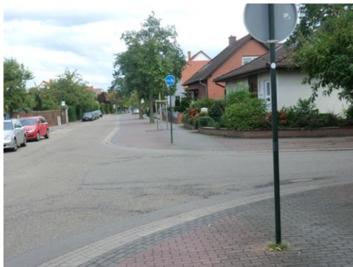
Abbildung 19: Problematik von benutzungspflichtigen Radwegen in Tempo-30-Zonen: (1) Hindernisse auf Radweg; (2) Parken auf Radweg; (3) Keine Furtmarkierung zulässig aufgrund Rechts-vor-Links; (4) Übergänge problematisch [Fotos: R+T]
