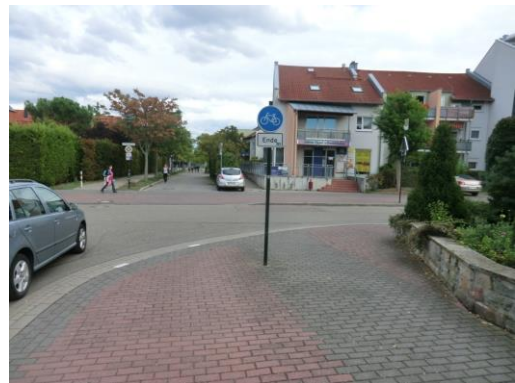
Abbildung 19: Problematik von benutzungspflichtigen Radwegen in Tempo-30-Zonen: (1) Hindernisse auf Radweg; (2) Parken auf Radweg; (3) Keine Furtmarkierung zulässig aufgrund Rechts-vor-Links; (4) Übergänge problematisch [Fotos: R+T]
