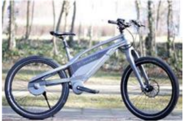
Beim X-Pesa wird die Kraft elektrisch übertragen
