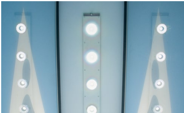
Innenleben eines innenbeleuchteten Verkehrszeichens mit LED-Technik
