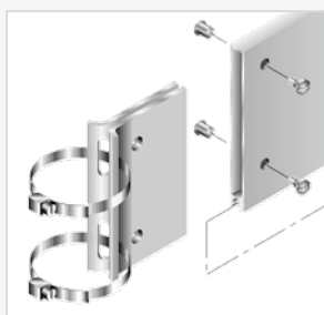
seitlich mit FUVIAL-Bandschelle für Schilderhöhe 150 mm oder 200 mm Ø >76 mm mit Schellenband
