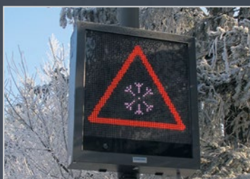
Die Glättewarnung wird beim Unterschreiten einer vorab eingestellten Temperatur automatisch angezeigt
