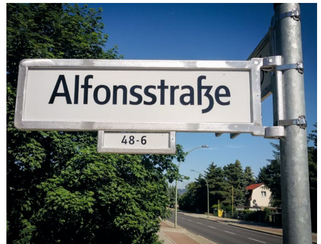
Straßenbenennungsschild mit Hausnummern-Einschub nach „Umklappregel“
