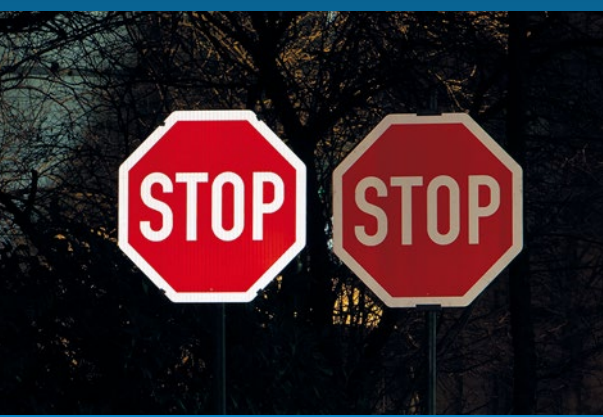
Verkehrszeichen, die ihre volle Reflexionskraft besitzen, werden schneller und früher erkannt. Dies kann unter Umständen lebensrettend wirken.
