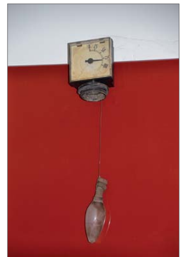
Not macht erfinderisch: die interessante Produkt-Ausstellung im Klingenhagen zeigt auch Kuriositäten wie den Ölstandsmesser eines Kunden Marke Eigenbau
