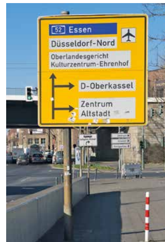
Falsche Grundfarbe: Innerortswegweisung ist weiß
