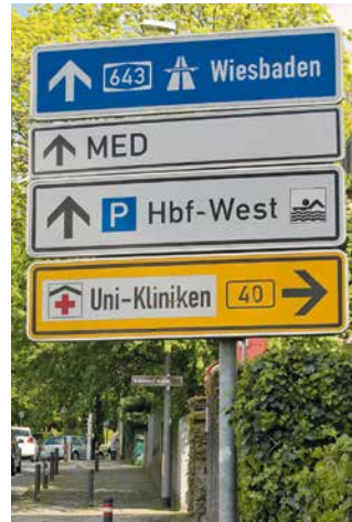
Aufgelöster Tabellenwegweiser (Farbeinsatz nach RWB hier unzulässig)
