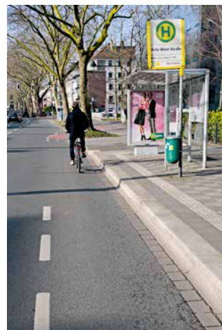
Radverkehrsführung auf der Fahrbahn im Bereich einer Haltestelle
