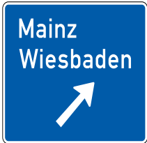
Z 332-20 Ausfahrttafel auf der Autobahn
